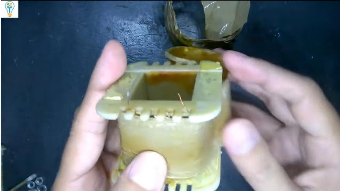
Luego se va a envolver el cable del embobinado secundario de 30 vueltas en 30 vueltas
