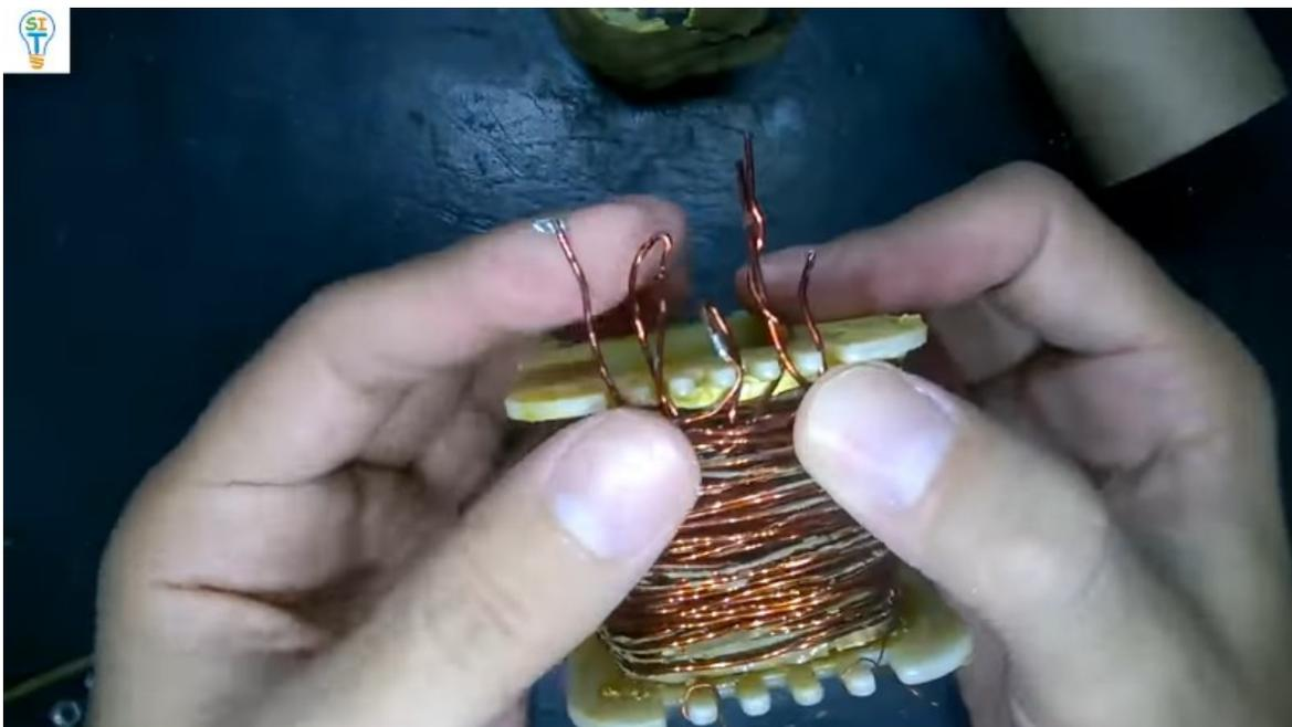
Antes de sellar el transformador debemos tomar en cuenta que el cable del embobinado primario es muy fino de 5mm por lo cual se le debe soldar unos cables porque si se trabajan con ellos directamente se puede correr el riesgo de que se partan o se dañen.
