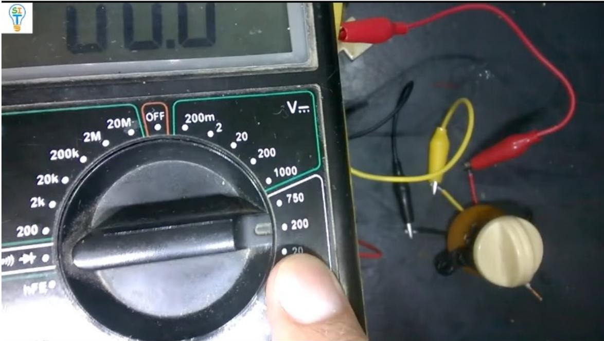
Se comenzara colocando el cable rojo del multímetro en el cable de salida que conecta el enchufe con el cable rojo del primario.
